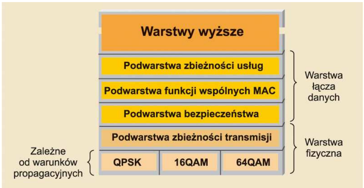
Rysunek 6 Stos protokołów dla standardu 802.16 (źródło ITPedia.pl)
